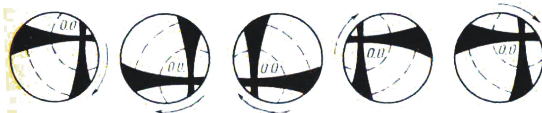
Рис. 17. Коноскопическая фигура одноосного кристалла в косом разрезе (стрелками показано направление вращения столика)
