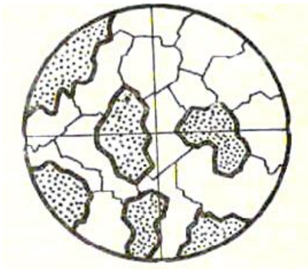
Рис. 6. Резкие ограничения и шагреновая поверхность у минералов с высоким показателем преломления
